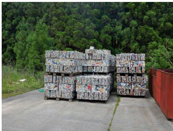
アルミ缶・スチール缶の圧縮ブロック
